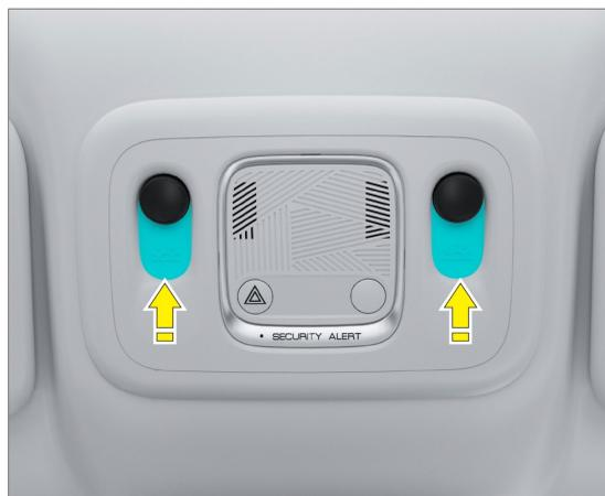
Toque el interruptor de la luz de techo delantera para encender o apagar la luz correspondiente.
