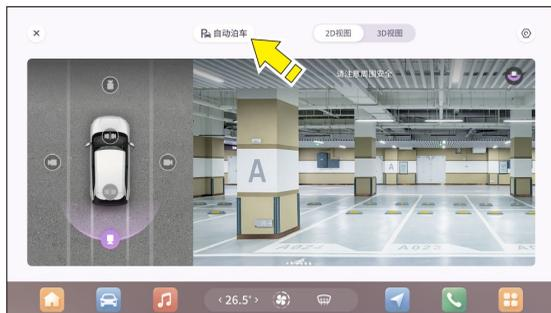
1. Encienda la luz READY, ingrese a la interfaz de imagen panorámica en la barra de menú rápido, presione el botón de asistencia de estacionamiento automático, cambie a la marcha D y active la función de estacionamiento automático para entrar automáticamente en la interfaz de búsqueda de espacios de estacionamiento;
