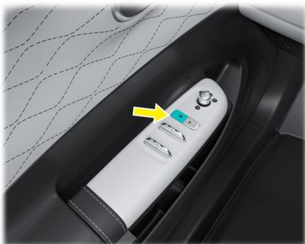
Presione el interruptor de desactivación de las ventanas del pasajero mostrado en la imagen para deshabilitar la función de los interruptores de las ventanas de los pasajeros delanteros y traseros. Sin embargo, el interruptor de la ventana del lado del conductor puede operar para subir y bajar. Presione el interruptor nuevamente para desactivar la función de bloqueo.
