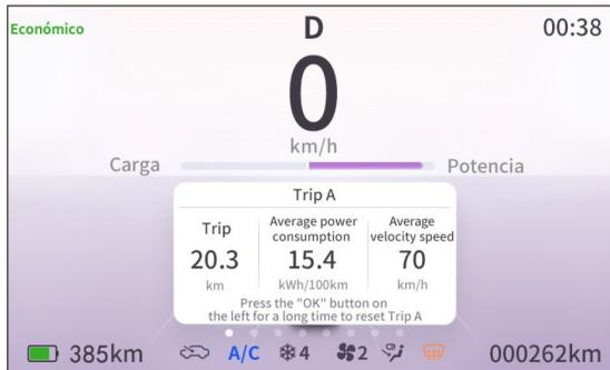
Presione el botón de cambio
