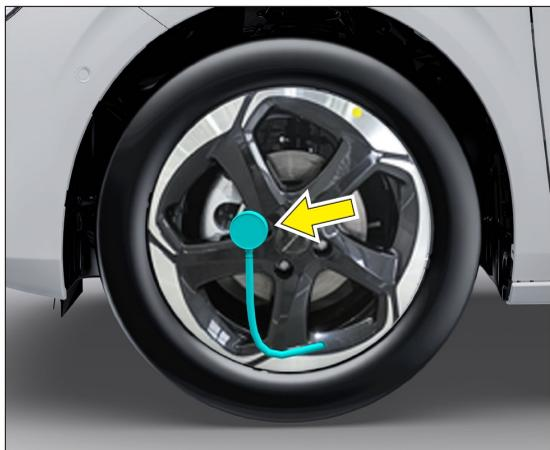
2. Coloque el manómetro en la válvula del neumático, lo que mostrará la presión del neumático.
