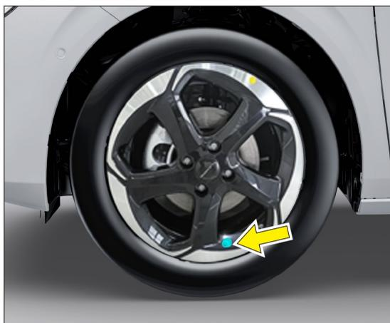
1. Retire la tapa de la válvula del neumático y use el método de la solución jabonosa para verificar si hay fugas en la válvula.
