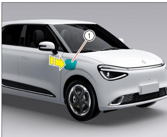
1. Asegúrese de que la cubierta antipolvo del puerto de carga esté colocada;
