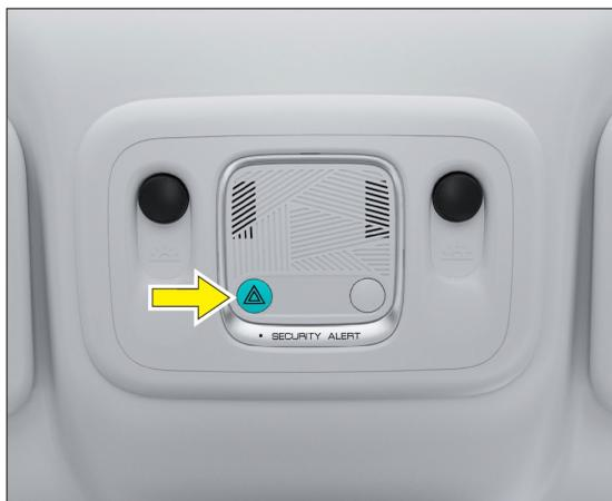
El interruptor de las luces de advertencia de peligro se encuentra en el panel de interruptores de la luz de techo delantera. En caso de emergencia, use las luces de advertencia de peligro para alertar a otros usuarios de la vía y evitar accidentes de tráfico.
