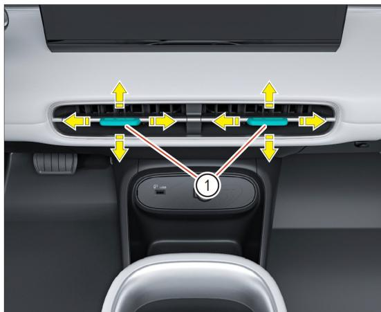
Mueva el botón de control ① para ajustar la dirección del flujo de aire (arriba/abajo, izquierda/derecha) de la salida de aire a la posición deseada. Deslice el botón de control ① hacia adentro hasta el límite para cerrar la salida de aire.
