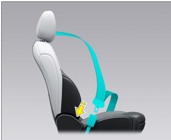
En caso de frenado de emergencia o colisión del vehículo, el cinturón de seguridad puede retener al conductor y pasajeros en sus asientos, previniendo colisiones secundarias con otras partes del interior del vehículo y asegurando la protección óptima por parte de las bolsas de aire.
