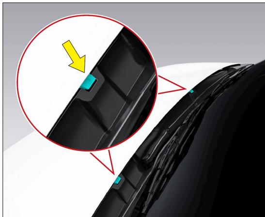
Si hay residuos cerca de los inyectores del lavaparabrisas, límpielos a tiempo, de lo contrario, pueden afectar el funcionamiento normal del lavaparabrisas.
