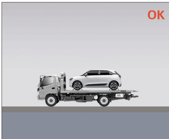
Se recomienda utilizar preferentemente el método de remolque con plataforma, donde el vehículo es cargado directamente en el camión de rescate, siendo este el mejor método para transportar el vehículo.
