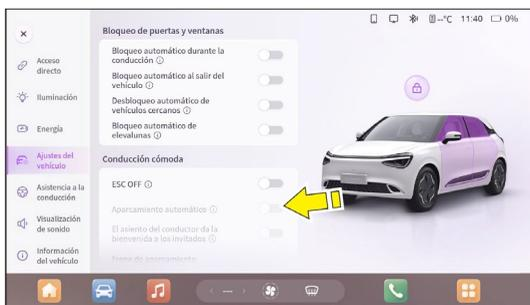
Puede activar/desactivar la función Auto Hold en la interfaz de conducción conveniente de MP5 en la configuración del vehículo.
