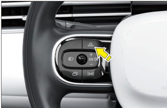
Modelos sin MP5: Presione el botón de modo de conducción en el lado izquierdo del volante multifunción para cambiar el modo de conducción, hay 3 modos disponibles: modo económico, modo confort, modo movimiento.
