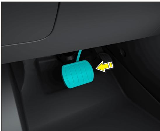
Lleve consigo la llave inteligente, desbloquee y entre en el vehículo, pise el pedal de freno, el vehículo arrancará y entrará en estado READY, y la luz indicadora READY del panel de instrumentos se encenderá.
