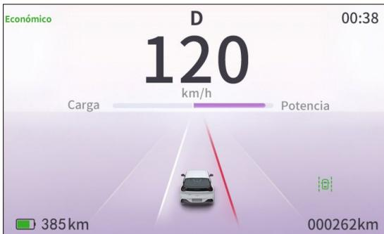
Si la cámara de conducción inteligente ubicada en la parte superior del parabrisas delantero detecta que el vehículo está saliendo de su carril de conducción, bajo las condiciones adecuadas, la advertencia de salida de carril (LDW) alertará al conductor con una advertencia visual, mostrando la línea del carril en rojo y destacada, y al mismo tiempo con una advertencia sonora.
