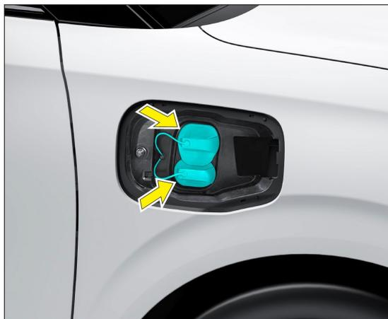
Retire la cubierta antipolvo para exponer los puertos de carga.
