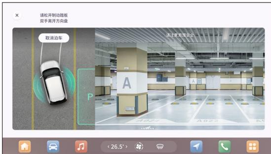
5. Una vez seleccionado el espacio de estacionamiento, la pantalla MP5 mostrará "Por favor, suelte el pedal del freno y retire las manos del volante". Después de que el conductor confirme que el entorno circundante es seguro, suelte el pedal del freno y retire las manos del volante, el sistema comienza a estacionar automáticamente el vehículo en el espacio;
