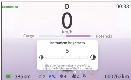
Modelos sin MP5: Presione el botón de cambio ① hasta la interfaz de ajuste de Visualización y ajuste el brillo con la rueda ②.
