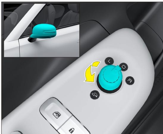
Gire el interruptor de plegado eléctrico del espejo retrovisor, ubicado en el apoyabrazos de la puerta del lado del conductor, para plegar/desplegar el espejo retrovisor exterior.
