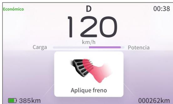
Cuando hay un riesgo de colisión por delante, el vehículo realizará una advertencia de emergencia, la luz indicadora del panel de instrumentos
