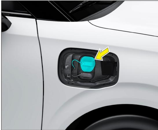
1. Antes de la descarga, asegúrese de que no haya fallos en el sistema de alta tensión del vehículo y cambie la fuente de alimentación del vehículo al modo "ON";
