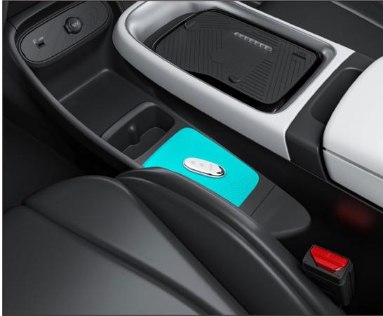
Cuando la batería de la llave inteligente esté baja, después de asegurarse de que todas las puertas estén cerradas, coloque la llave inteligente en el área de arranque de emergencia (como se muestra en la imagen), pise el pedal del freno para arrancar el vehículo en caso de emergencia.
