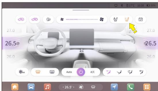
Después de energizar el vehículo, toque la interfaz de aire acondicionado en MP5 para activar y ajustar la función de calefacción del asiento del conductor.
