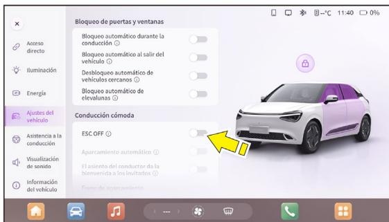
En determinadas condiciones (cuando el vehículo arranca en barro, nieve o superficies sueltas), en la pantalla Ajustes del vehículo MP5 → Conducción cómoda, y la luz indicadora de desactivación de ESC en el panel de
