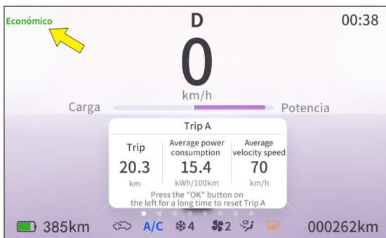
Puede verificar la indicación del modo de conducción en la esquina superior izquierda del panel de instrumentos.
