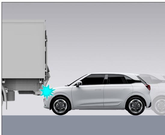
Cuando se produce una colisión por alcance con un camión grande y el vehículo se desliza debajo, la bolsa de aire frontal puede no desplegarse.
