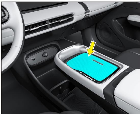
La zona de detección de carga inalámbrica para teléfonos móviles se encuentra en la parte frontal del tablero de instrumentos.
