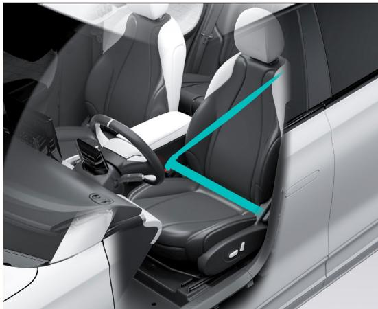
El cinturón de seguridad debe colocarse sobre el esqueleto del cuerpo. En la parte superior del cuerpo, la sección superior del cinturón debe estar ajustada contra el pecho y pasar sobre el hombro. En la parte inferior del cuerpo, la sección inferior del cinturón debe estar ajustada sobre el hueso de la cadera, y no debe colocarse sobre el abdomen.
