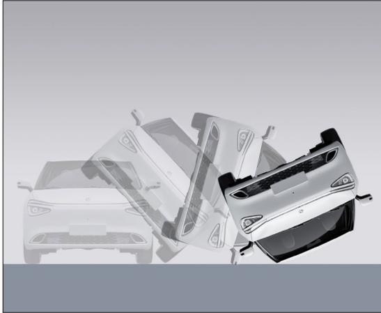
En accidentes de vuelco lateral o de rodadura lateral, la bolsa de aire frontal puede no desplegarse.
