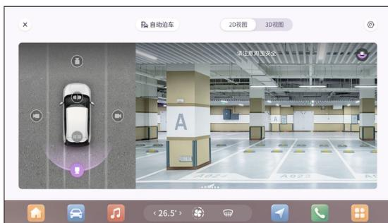
Si el vehículo está equipado con imagen panorámica de 360°, el conductor puede observar el entorno alrededor del vehículo en todas las direcciones.
