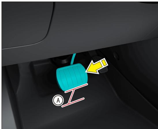
Después de encender el vehículo, revise la distancia A desde la posición inicial del pedal hasta la alfombra. Si la distancia no está dentro del rango especificado, por favor contacte con el concesionario.
