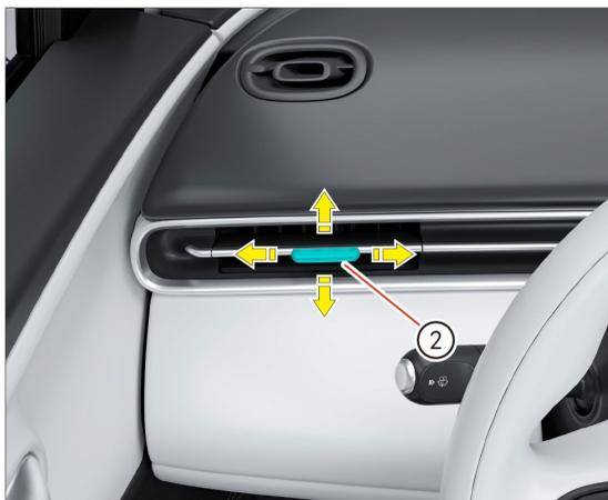
Mueva el botón de control ② para ajustar la dirección del flujo de aire (arriba/abajo, izquierda/derecha) de la salida de aire a la posición deseada. Deslice el botón de control ② hacia adentro hasta el límite para cerrar la salida de aire.
