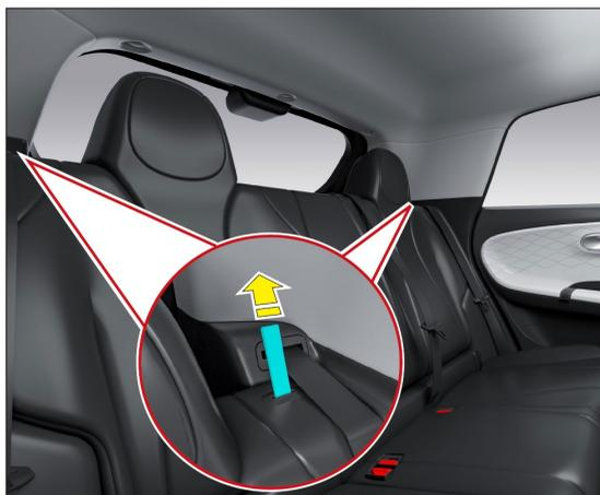
El respaldo del asiento trasero se puede plegar completamente para ampliar el volumen del maletero.
