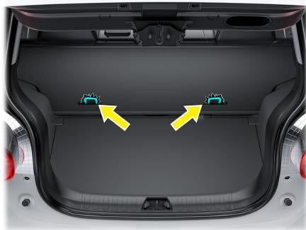
El vehículo está equipado con 2 conjuntos de dispositivos de fijación para asientos infantiles ISOFIX, cada conjunto incluye un soporte de anclaje superior (indicado por la flecha en la imagen) y dos soportes de anclaje inferiores.
