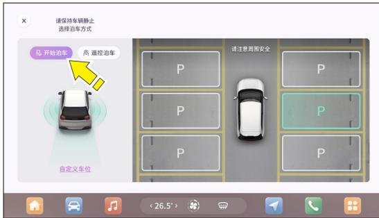
2. Mantenga la velocidad del vehículo por debajo de 15 km/h, el vehículo a una distancia de 0.5 m a 2.0 m de un objeto de referencia del espacio de estacionamiento y mantenga el vehículo en línea recta, el sistema comienza a buscar un espacio de estacionamiento. Cuando el sistema encuentra un espacio de estacionamiento, la pantalla táctil muestra "Mantenga el vehículo detenido, elija el modo de estacionamiento" y muestra los espacios de estacionamiento disponibles actualmente;
