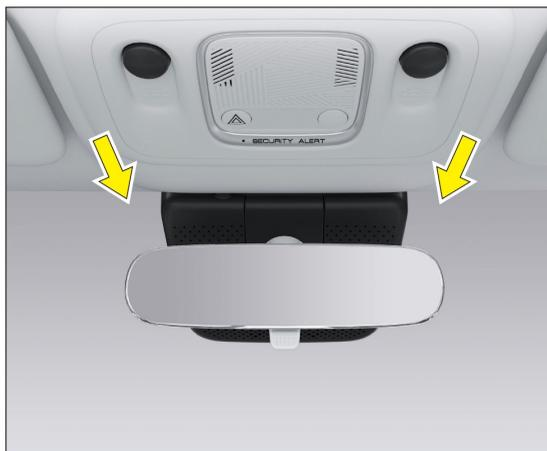
La ventana de microondas se encuentra alrededor del espejo retrovisor interior, y en esta área se pueden instalar dispositivos de comunicación, como ETC, control de acceso, estacionamiento inteligente, etc. No se permite pegar películas solares, etc., para garantizar la lectura efectiva de los datos.
