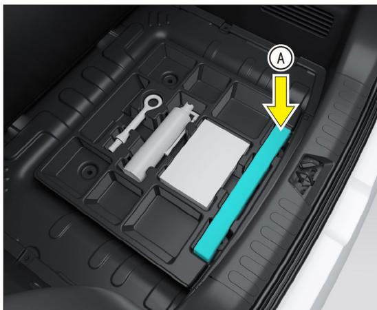
El triángulo de advertencia se encuentra debajo del piso del maletero, en el soporte de espuma A. Levantando la manija del piso del maletero y abriendo el piso del mismo, se puede ver.
