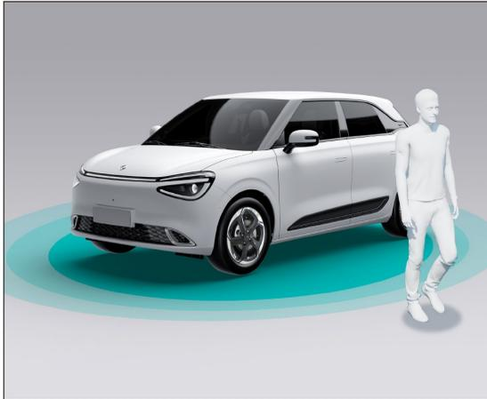
Cuando la función de bloqueo automático al alejarse está activada, con la palanca de cambios en posición P, todas las puertas cerradas (incluida la puerta trasera), lleve la llave consigo y al alejarse del vehículo (en dirección perpendicular a la manija de la puerta del lado izquierdo o a la puerta trasera) a aproximadamente 3 m, las puertas se bloquearán automáticamente, las manijas de las puertas retráctiles se retraerán automáticamente\*, y todas las luces direccionales parpadearán 1 vez.
