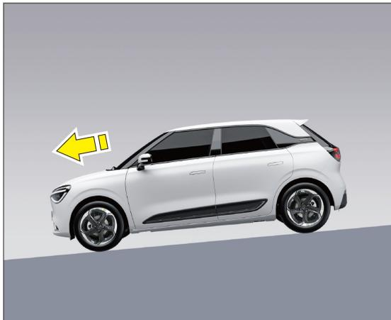
Al conducir cuesta abajo, al soltar el pedal del acelerador o al pisar ligeramente el pedal de freno, el vehículo comenzará a frenar.
