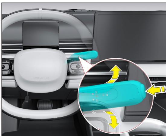
Después de que la luz indicadora READY del panel de instrumentos se ilumine, pise el pedal del freno y mueva la palanca de cambio electrónico hacia arriba o hacia abajo para cambiar las marchas.
