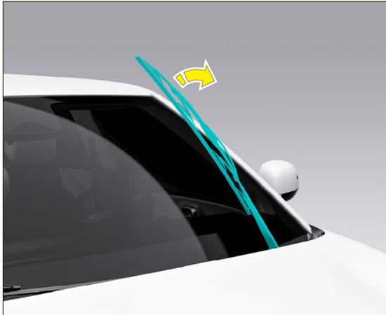
1. Levante el brazo del limpiaparabrisas para que se aleje del parabrisas. Coloque una toalla gruesa debajo del brazo del limpiaparabrisas para evitar que se golpee contra el parabrisas accidentalmente.
