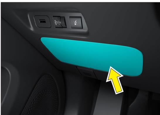
Retirando la cubierta en la parte inferior izquierda del tablero se puede acceder a la caja de fusibles del habitáculo.
