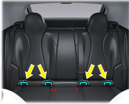
Los soportes de anclaje inferiores (indicados por la flecha en la imagen) están ubicados en la parte inferior del respaldo del asiento trasero, en el punto de conexión con el cojín del asiento, al lado de la etiqueta "ISOFIX". Los soportes se pueden ver al abrir la tapa del puerto reservado.
