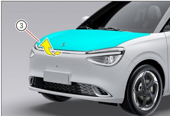
3. Levante la tapa del compartimento del tren motriz③ hacia arriba.
