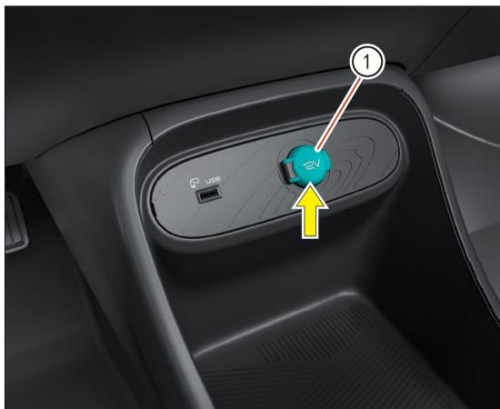
Hay una toma de corriente de 12V ① ubicada en la parte frontal del tablero de instrumentos auxiliar.
