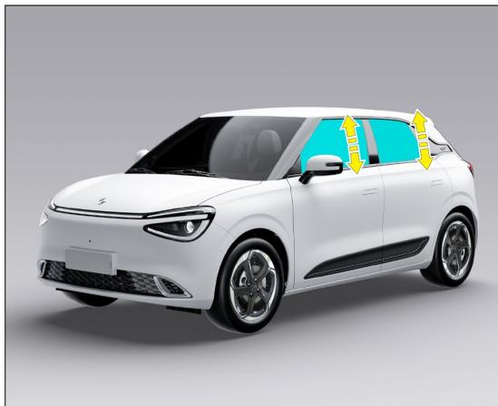
Después de apagar el vehículo, mantenga presionado el botón de bloqueo/desbloqueo del llavero inteligente para controlar el ascenso/descenso automático de las ventanillas.
