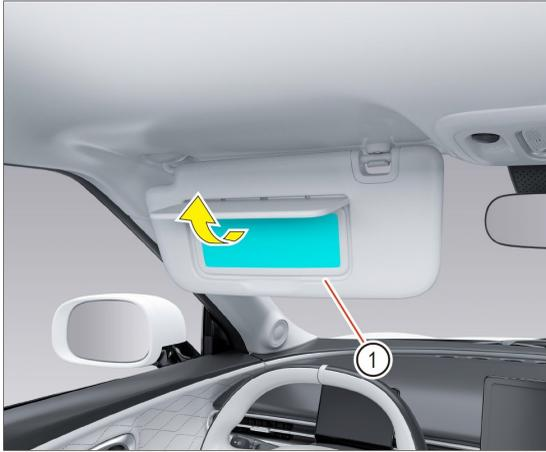
El espejo de cortesía se encuentra en la parte trasera de la visera, simplemente gire hacia abajo la visera ① para usar el espejo de cortesía.
