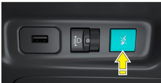
Modelos con interruptor físico de desconexión: Mantenga presionado el interruptor de desconexión en el lado izquierdo del tablero de instrumentos para apagar el vehículo.
