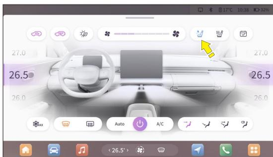
Después de energizar el vehículo, toque la interfaz de aire acondicionado en MP5 para activar y ajustar la función de ventilación del asiento del conductor.
