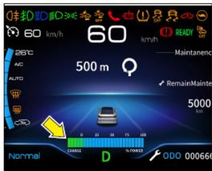
Medidor de potencia y retroalimentación de energía del motor de accionamiento
